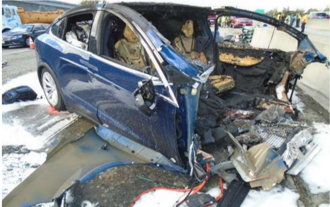
Joonis 5. Avarii, kus on toimunud põleng ning on nähtavad kõrgepingekomponendid [13]
